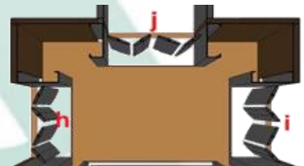
Kleppensectie voor aanzuigen van binnenlucht (h), buitenlucht (i) en gedroogde lucht (j) van de centrale luchtdroger.
