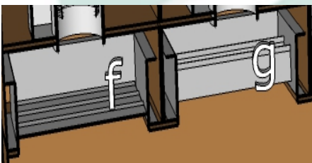
Een kleppensectie wordt geopend (g) wanneer de droging van die sectie actief is en blijft gesloten (f) wanneer de droging uit is.
