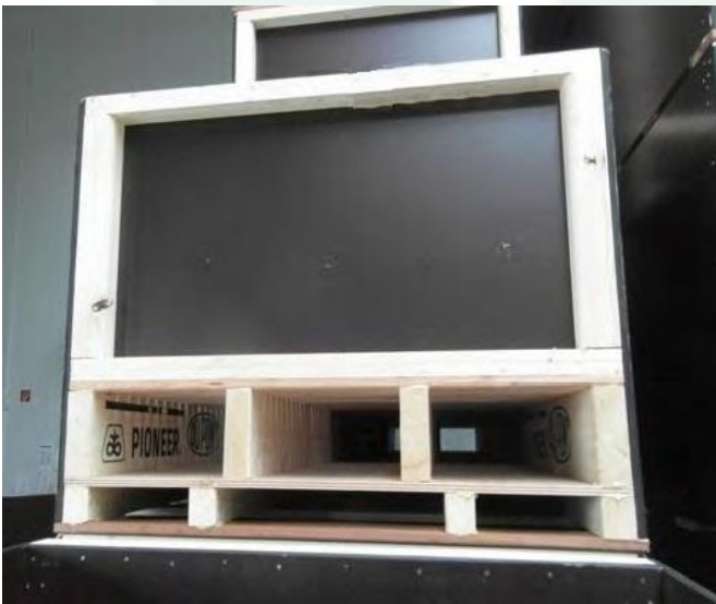
Voorbeeld van een droogkist met dubbele pallet: Ventilatie en transport. Kist met een betonplex buitenkant.
