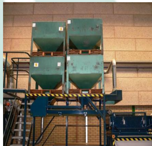
Zaad aanvoer met 2 rijen doseerkisten. Vanuit de bovenste kist(en) wordt de onderste kist gevuld; extra capaciteit voor continu proces.
